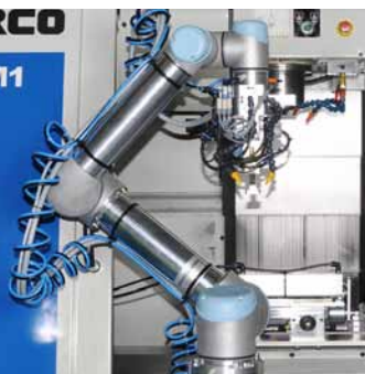
Robot otvára oboje dvierka, vkladá suroviny, utáhuje zverák stroja, znovu ich odstraňuje po frézovaní a ukladá ich na jednu stranu.
