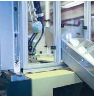
Robot je bezpečne vstavaný do vstrekovacej lišty stroja môže sa pohybovať nad formou a vytáhať plastové predmety. To sa vykonáva pomocou špeciálne navrhnutého vákuového systému, ktorý zaisťuje, že sa citlivé predmety nepoškodia.
