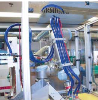
Spoločnosť Oticon taktiež využíva robota na rôzne úlohy v zlievarni, kde sa vymení nasávací nástroj za pneumatický zachytávací nástroj používaný na manipuláciu so zložitejšími odliatymi súčiastkami. Robot pracuje v cykloch 4 - 7 sekúnd.
